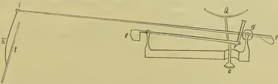
die zunächst den Hebel *er* bewegt, der durch auf die Schale *Q* gelegte kleine Gewichte nach Bedürfniss herabgedrückt wird, und durch die Zahnstange das Zahnrad *g* und durch dieses den Schreibhebel *ei* in Bewegung setzt, der mittelst einer durch Scharniergelenk befestigten, leicht gebogenen Nadel *k* auf der Platte *t* schreibt.
